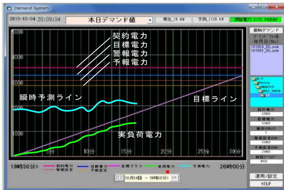
同一システムで運用可能なデマンド監視画面
