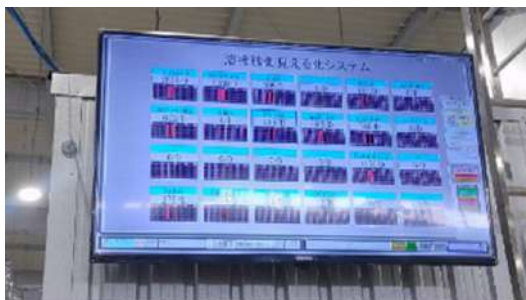
溶接電流で稼働/停止に変換した現場の画面
